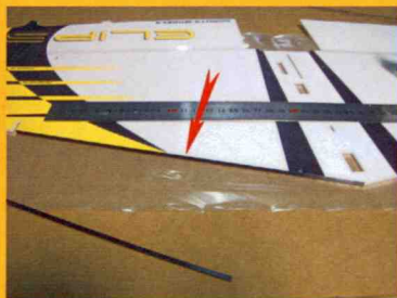
Collez le premier plat sur le bord d'attaque de l'aile comme indiqué par la flèche.
