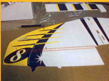
Articulez les ailerons avec du ruban adhésif. Laissez un espacement de 0.5mm entre l'aileron et l'aile.
