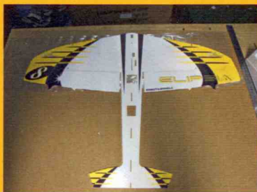
Collez la partie horizontale arrière du fuselage et vérifiez la rectitude.
