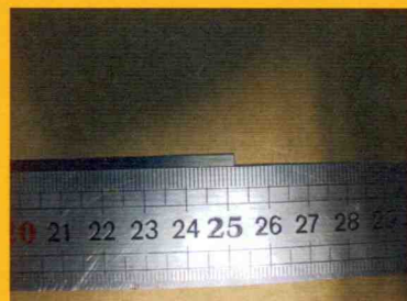
Coupez 2 morceaux de 257mm de plat de carbone 3x0.5mm.
