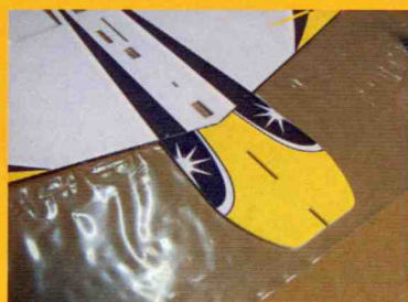
Collez la partie horizontale avant du fuselage en vérifiant la rectitude.
