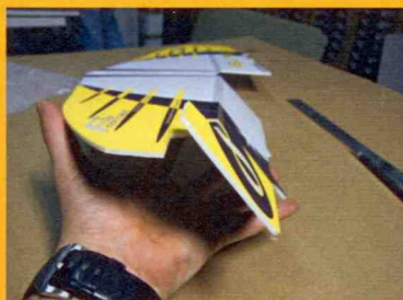
Vérifiez que l'aileron débatte correctement, sans point dur d'au moins 60°
